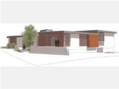
**So wird der Neubau aussehen: Rechts ist der gegenüber dem übrigen Gebäude höhere Saal zu sehen. Hinter den Vorsprüngen in der Fassade (braun) verbergen sich Lagerräume. Computergrafik: nh**
